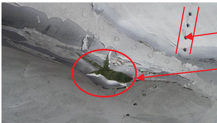
Фото 22. Характер повреждений обшивки Boeing 777
