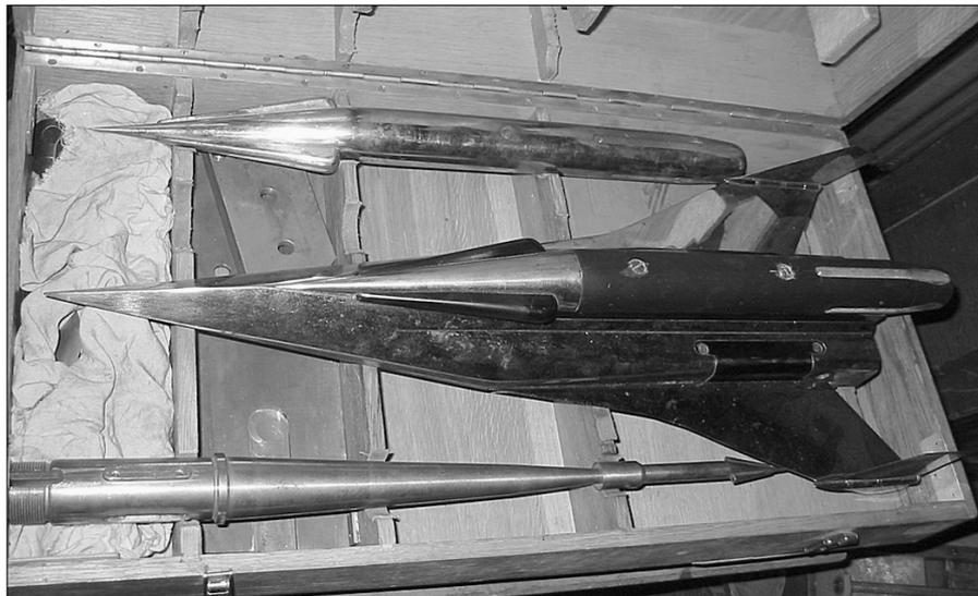
Металлическая модель ВОС «Спираль» в транспортном контейнере, использованная при испытаниях в аэродинамических трубах. Обращает на себя внимание острая верхняя кромка в носовой части гиперзвукового самолета-разгонщика. Модель позволяла исследовать различные конфигурации крыла, включая различные формы аэродинамической крутки и расположение управляющих поверхностей, и имела сменные модули полезной нагрузки.
